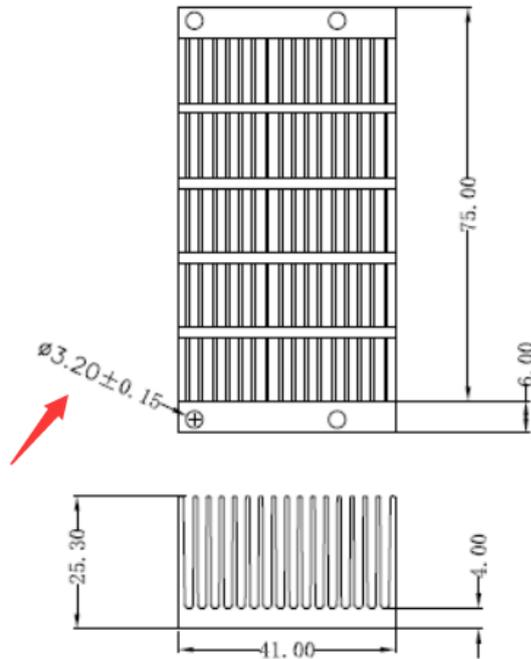
图 7-3 MYC-JX8MPQ 散热器尺寸图
