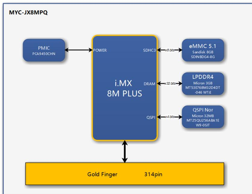
图 2-1 MYC-JX8MPQ 核心板系统框图
