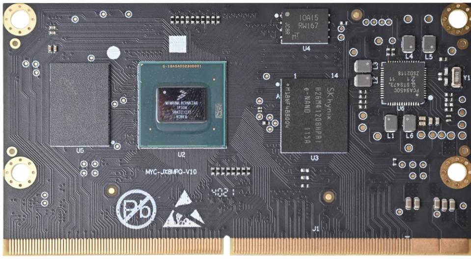
图 1-1 MYC-JX8MPQ 核心板
