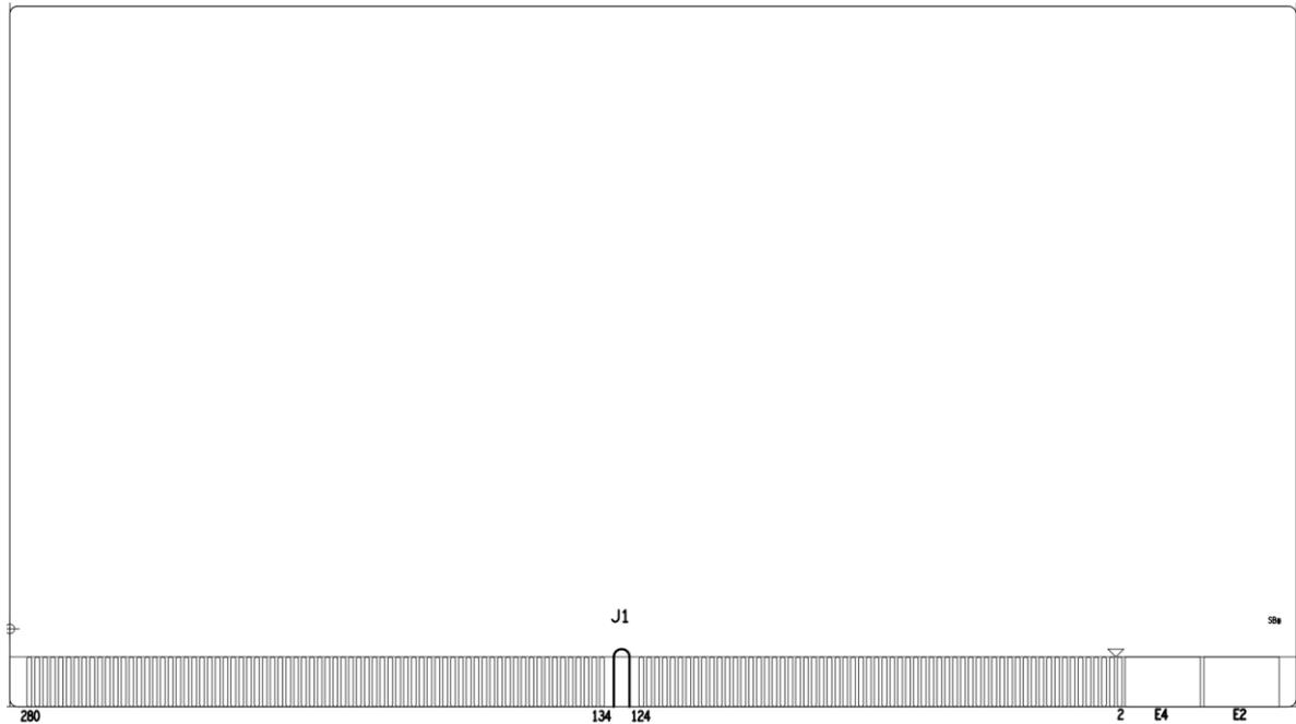
图 3-1 模块引脚图 (Top 层)
